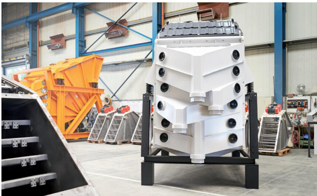
Vista de MSizer extend, bocas de salida hexagonales
